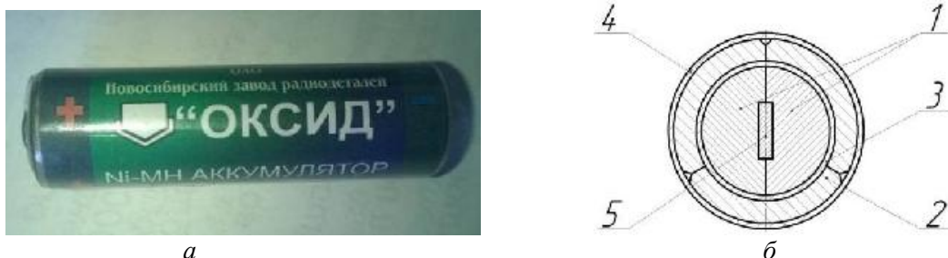
Рис. 1. Аккумулятор НЛЦ-0,9: а – общий вид, б – разрез.
