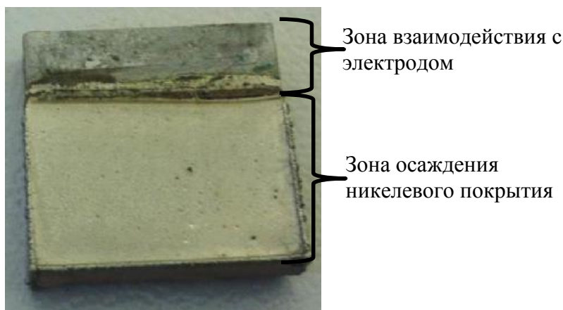
Рис. 5. Образец с нанесенным покрытием при температуре электролита 34°С
