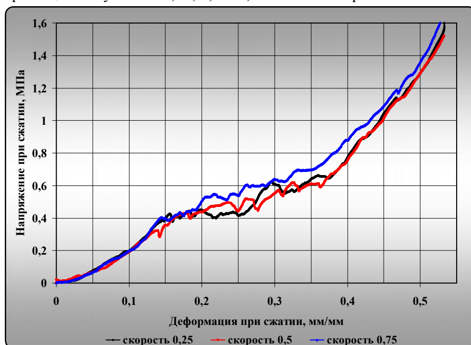
Рис. 4. Зависимость деформации при сжатии кубической упаковки со скоростями перемещения пуансона 0,25; 0,5 и 0,75 мм/с от напряжения
