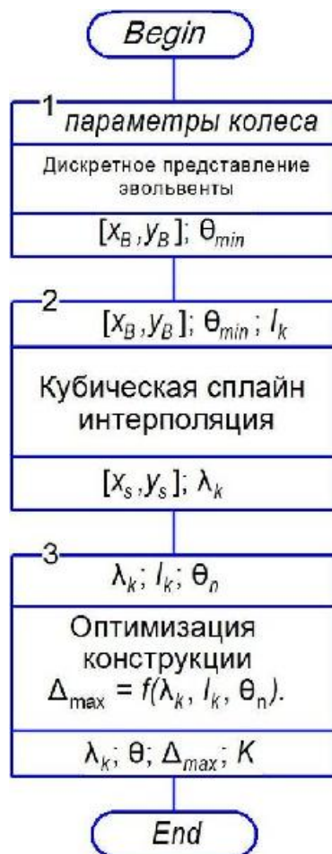
Рис. 2. Блок-схема алгоритма оптимизации проектных параметров гиперболоидной фрезы.
