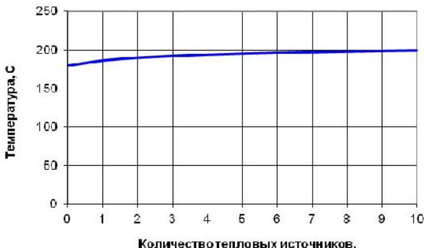
Рис.3. Влияние аккумуляции теплоты на температуру на поверхности отверстия
